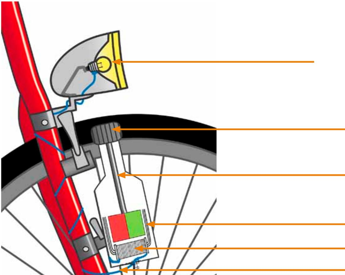
Um einen Stromkreis aufzubauen, braucht man immer zwei Drähte. Kannst du in der Zeichnung erkennen, wodurch der zweite Draht hier ersetzt wird? Die Geheimschrift hilft dir.
